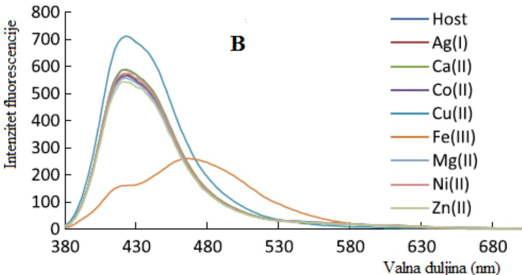
Slika 18.: Emisijski spektri spoja **6** u prisutnosti metalnih iona u smjesi otapala DMSO/CH<sub>3</sub>CN (3:8) (**A**) i u smjesi otapala CH<sub>3</sub>CN/H<sub>2</sub>O (1:1) (**B**), preuzeto iz [20].
