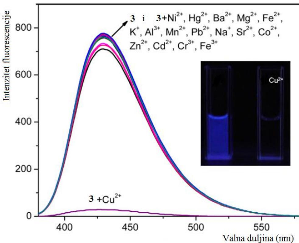
Slika 10.: Gašenje fluorescencije spoja **3** u prisutnosti bakrovnih iona, preuzeto iz [17].
