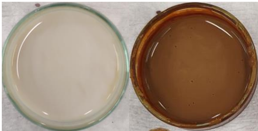
Slika 32. Prikaz srebrovog klorida otopljenog u smjesi etanola i polivinil butirala prije (lijevo) i nakon redukcije (desno).
