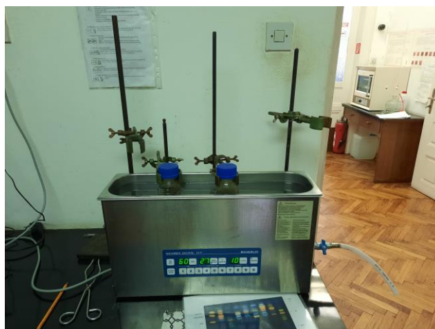
Slika 17. Ultrazvučna kupelj, Sonorex digital 10 P, Bandelin
