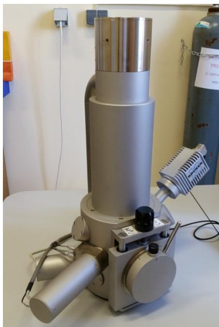
**Slika 23.** Pretražni elektronski mikroskop, *Tescan Vega serija 3, Bruker*
