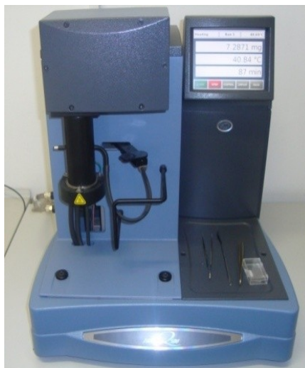
Slika 21. Termogravimetar, TA Instruments Q500
