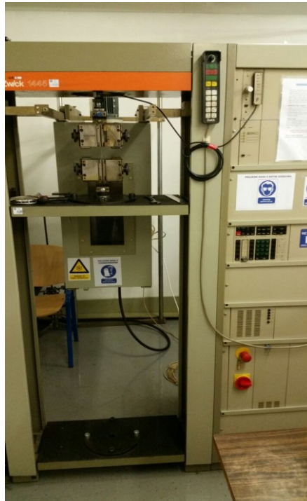
Slika 22. Univerzalni stroj za mehanička ispitivanja, Zwick 1445
