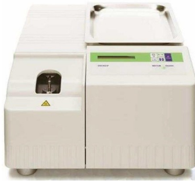
Slika 20. Diferencijalni pretražni kalorimetar, Mettler Toledo DSC 823e
