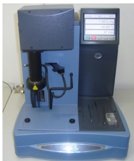
**Slika 21.** Termogravimetar, *TA Instruments Q500*
