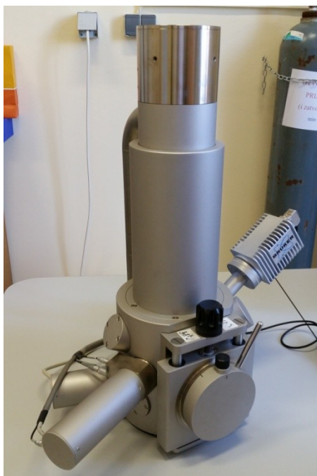
Slika 23. Pretražni elektronski mikroskop, Tescan Vega serija 3, Bruker
