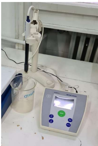
Slika 7. pH metar Mettler Toledo S20 SevenEasy
