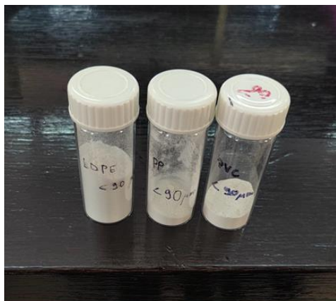
Slika 8. Mikroplastika LDPE-a, PP-a i PVC-a veličine čestica <90 µm.
