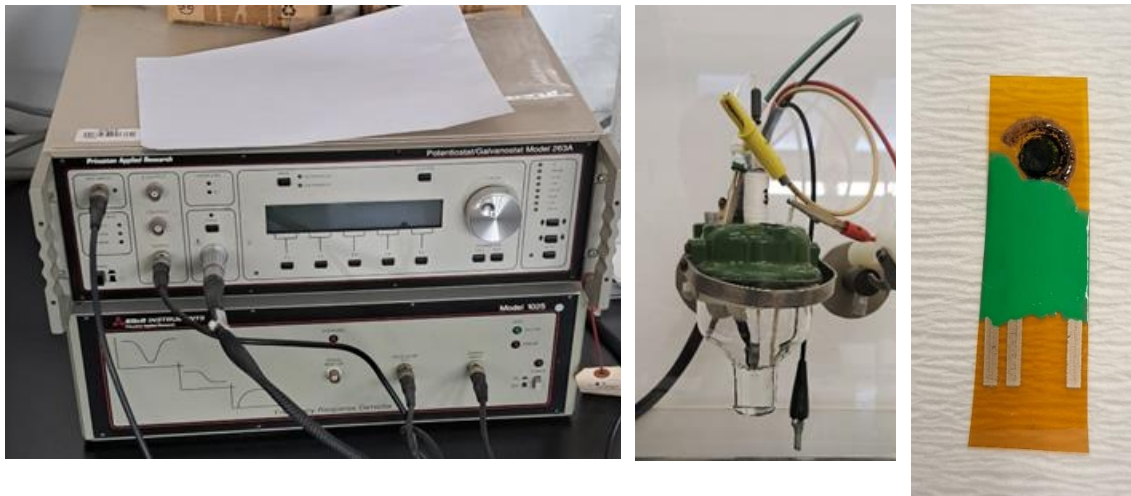
Slika 6. Prikaz aparature: potenciostat / galvanostat model 263A (lijevo), troelektrodna elektrokemijska ćelija s GC elektrodom (u sredini) i inkjet printana elektroda (desno).
