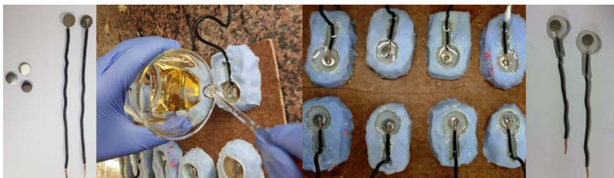
Slika 3.2. Postupak izrade radnih elektroda. 69
