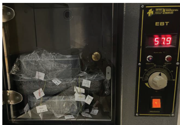
Slika 3.14. Posude s tlom i uzorcima papira tijekom provedbe pokusa biorazgradnje u termostatu pri 58 °C.
