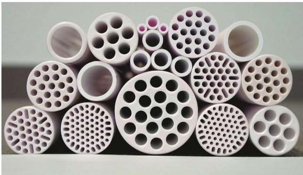
Slika 7. Poprečni prikaz nekih keramičkih nanofiltracijskih membrana [16]
