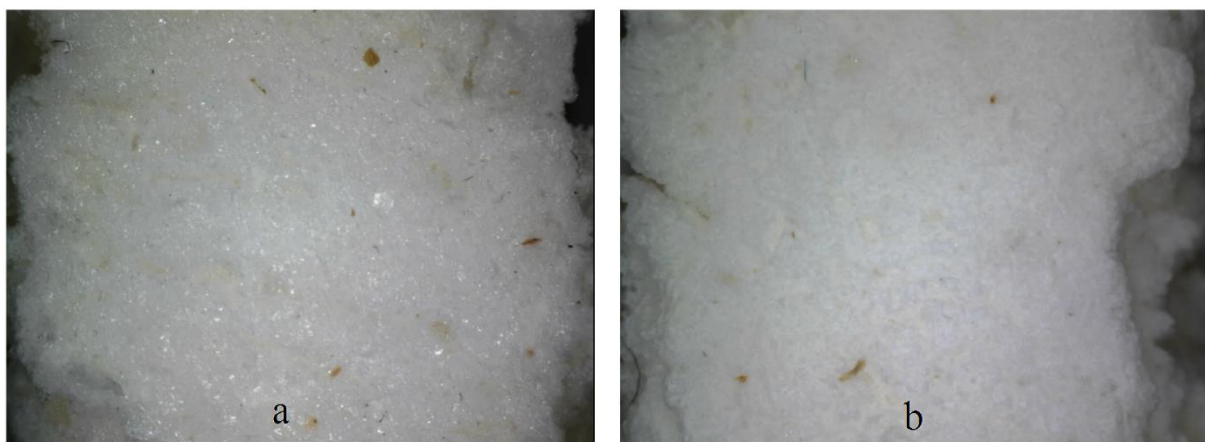
Slika 25 Prikaz donje površine uzorka PLA/EXP 16-5 prije jetkanja kloroformom (a) te nakon jetkanja (b)
