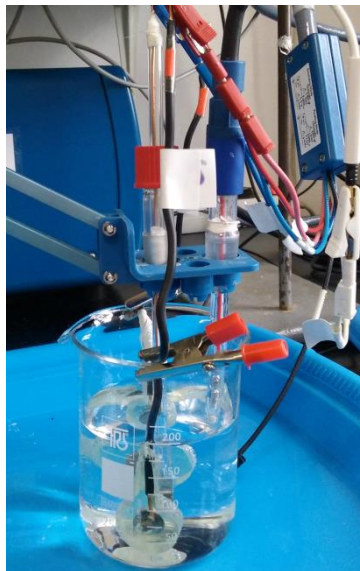
Slika 3.4. Troelektrodni sustav za elektrokemijska mjerenja
