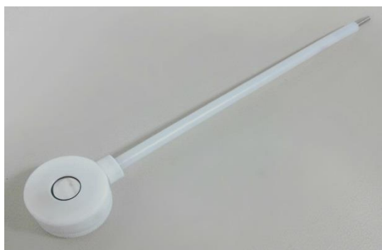
Slika 3.2. Držač elektroda za uzorke pripremljene u tetrahidrofuranu
