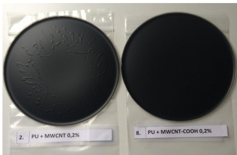
Slika 31. Prikaz dobivenih filmova nanokompozita sa 0,2 % MWCNT i 0,2% MWCNT-COOH
