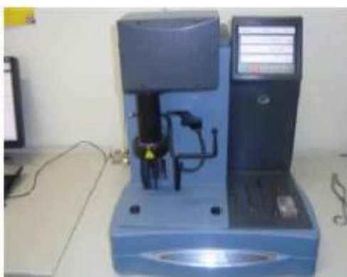
Slika 33. Termogravimetar TA Instruments Q 500
