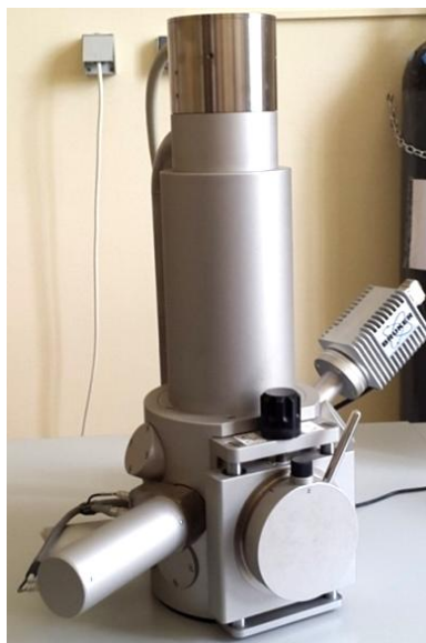
Slika 35. Pretražni elektronski mikroskop Tescan Vega 3, Bruker
