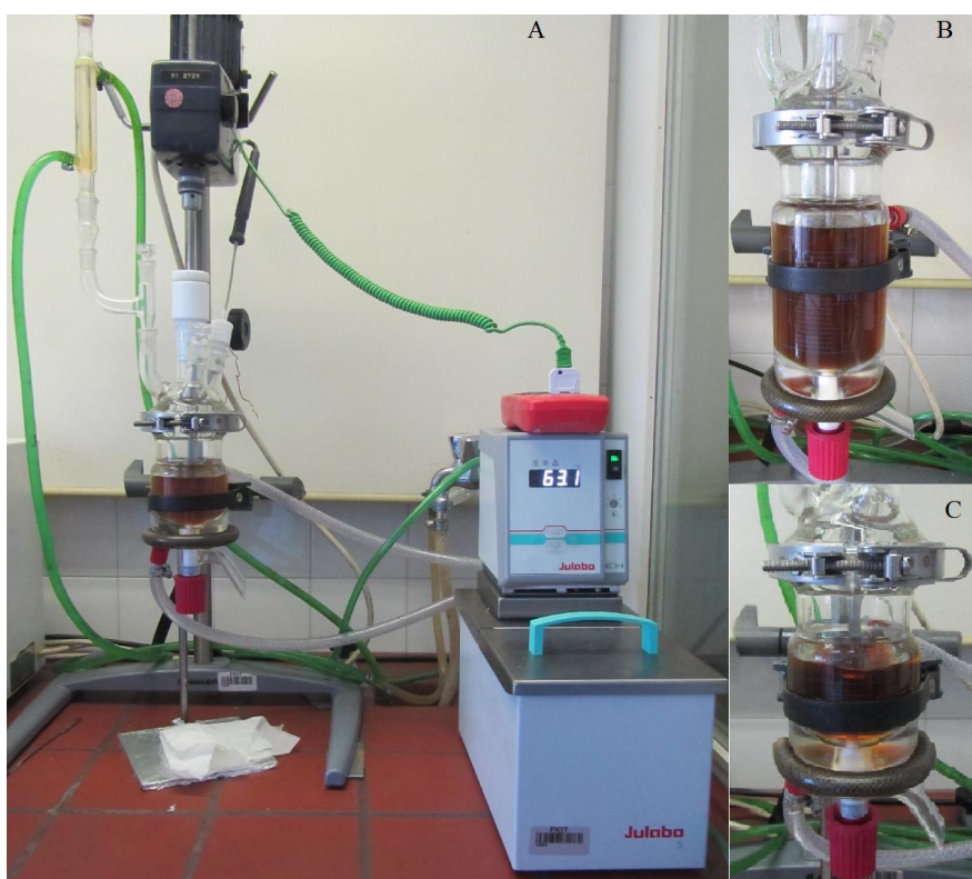
Slika 20: A- prikaz reaktora s popratnom opremom, B- reaktor od 250 mL, C- reaktor od 100 mL
