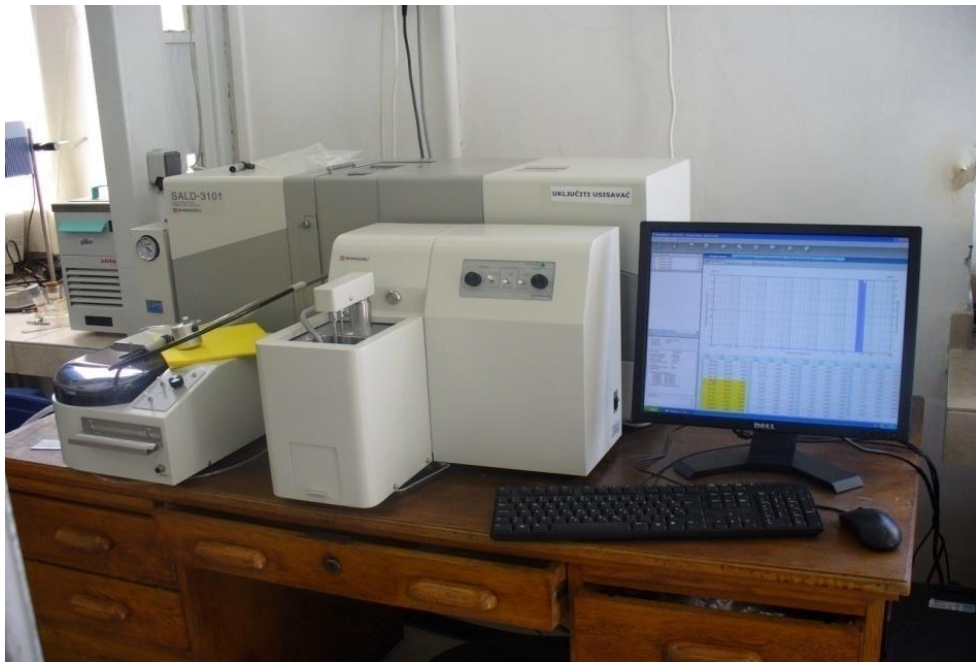
Slika 3.3. Fotografija uređaja za određivanje raspodjele veličine čestica metodom laserske difrakcije SALD – 3101 (Shimadzu, Kyoto, Japan).
