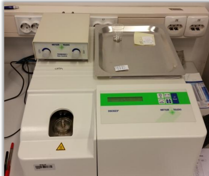
Slika 3.2. Fotografija diferencijalnog pretražnog kalorimetra (Zavod za inženjerstvo površina polimernih materijala, FKIT).
