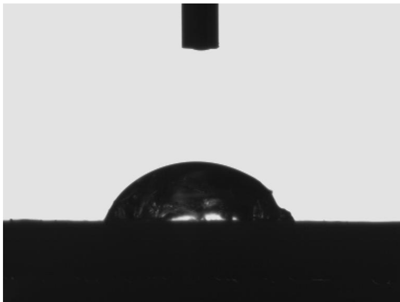
Slika 28. Reakcija kapljice vode na površini PE-LD uzorka na kojeg je nanesen silan DAMO
