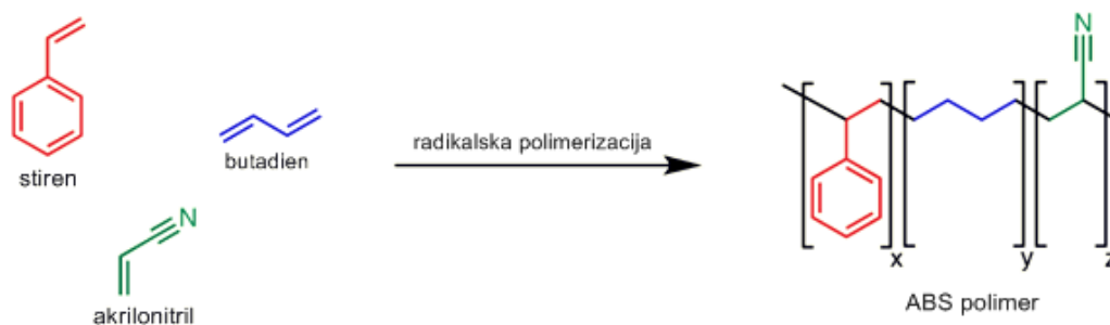
Slika 23. Radikalna polimerizacija kojom nastaje ABS iz monomera stirena, akrilonitrila i butadiena [18]
