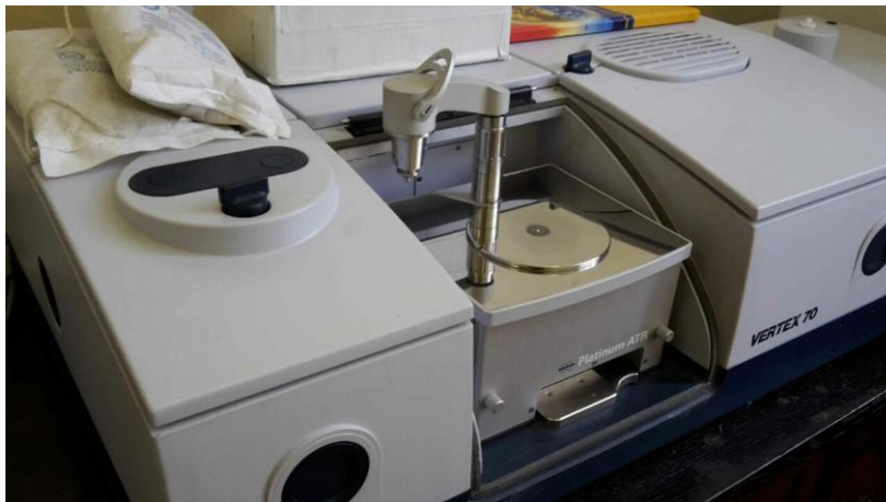
Slika 31. Uređaj za FTIR analizu- Bruker Vertex 70
