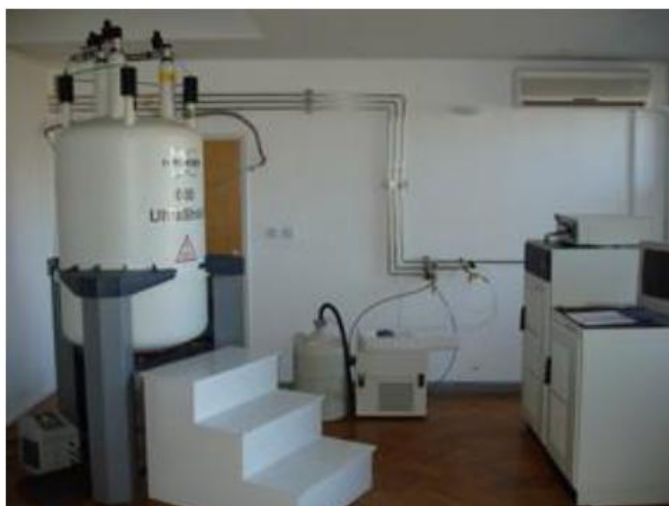
Slika 32. ^1\text{H} NMR Spektrometar Bruker Avance 300
