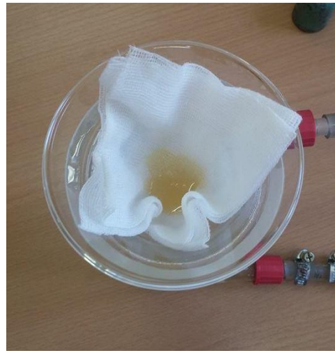
Slika 24. Uklanjanje glicerola filtracijom
