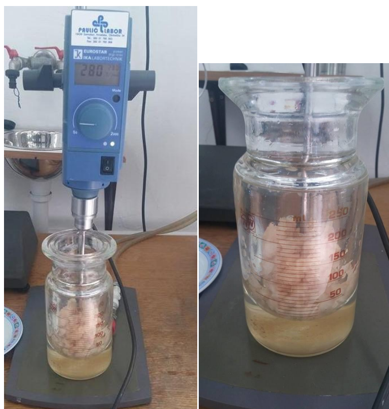
Slika 21. Otapanje masnoća u reaktoru uz miješanje
