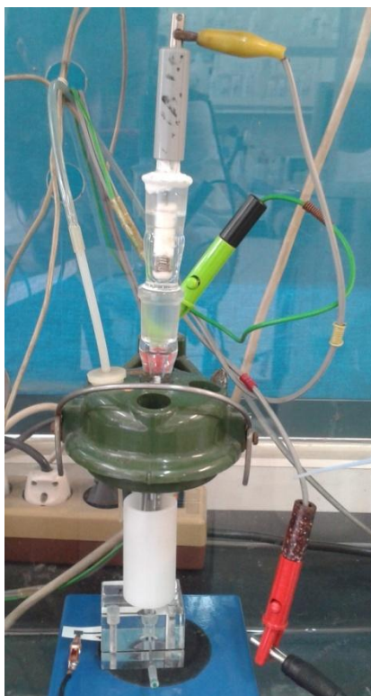
Slika 20. Aparatura za cikličko oslojavanje printane Ag elektrode polianilinom. Elektroda je prethodno oslojena vodljivom grafitnom tintom.
