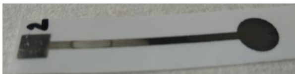
Slika 24. Ag elektroda nakon potenciostatske modifikacije.
