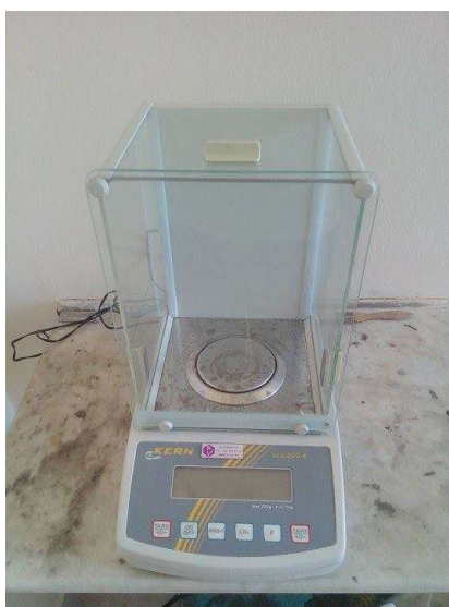
Slika 10. Analitička vaga ALS 220-4, Kern
