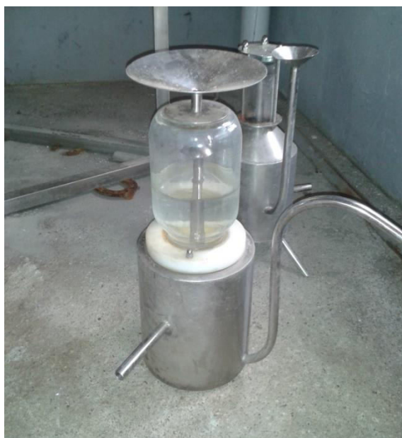
Slika 15. Firentinska posuda za odvajanje eteričnog ulja
