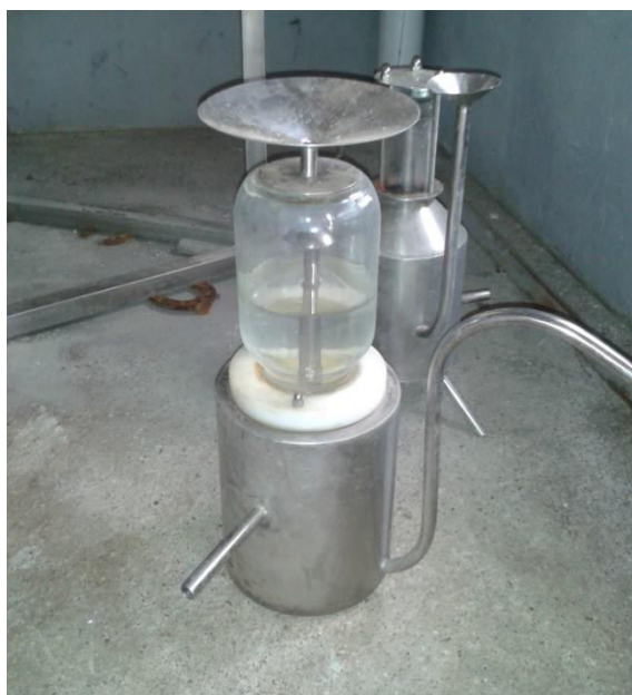
Slika 15. Firentinska posuda za odvajanje eteričnog ulja
