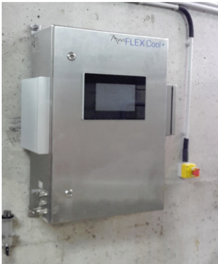
Slika 15 Uređaj za analizu sastava bioplina [41]
