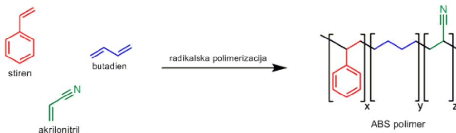
Slika 23. Radikalska polimerizacija kojom nastaje ABS iz monomera stirena, akrilonitrila i budadiena 28
