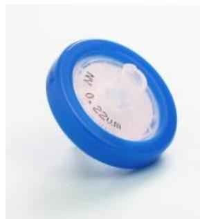
Slika 8. Filter za injekcije (0,22 µm)
