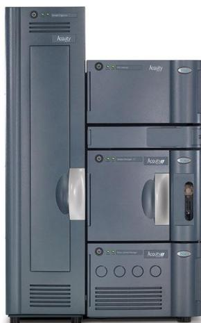
Slika 9. Tekućinski kromatograf ultravisoke djelotvornosti s MS detektorom [24]
