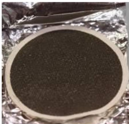
Slika 25. Uzorak frakcije lebdećih čestica \text{PM}_1 sakupljen na kvarcnom filtru
