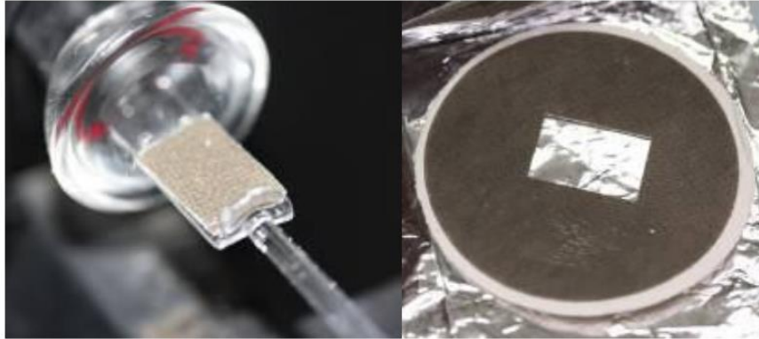
Slika 27. Lađica s alikvotom filtra koji ide u pirolitičku peć i filter nakon izrezivanja alikvota
