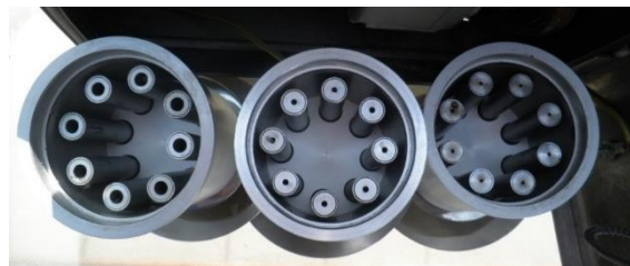
Slika 24. Mlaznice referentnih glava za sakupljanje frakcija lebdećih čestica PM 10 , PM 2,5 i PM 1
