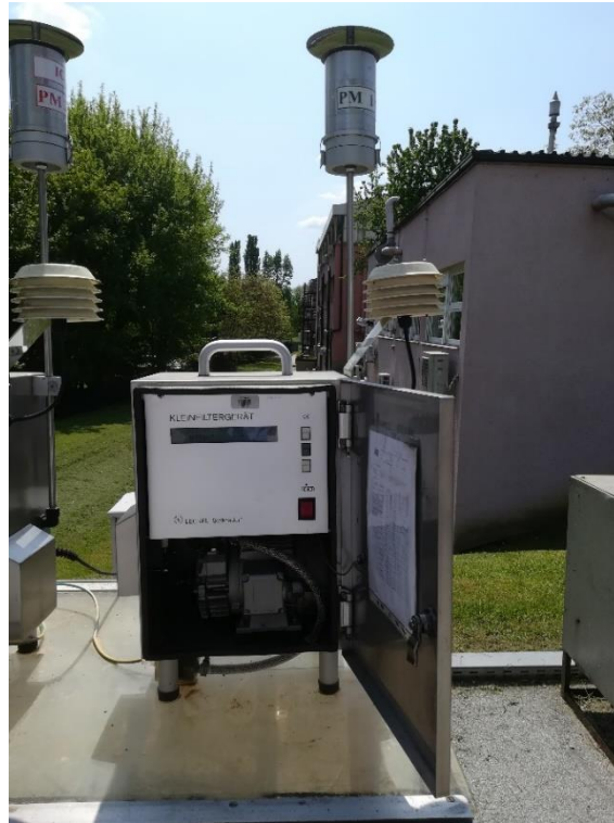
Slika 23. Referentni uređaj Sven Leckel LV3
