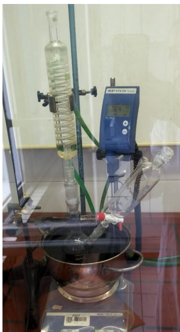
Slika 7. Aparatura za dobivanje klorida oleinske kiseline (izvor: vlastita fotografija autora)
