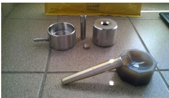
Slika 14. Aparatura za dobivanje pastila.
