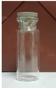
Slika 3.1. Kotlasti reaktor V = 5\text{ cm}^3
