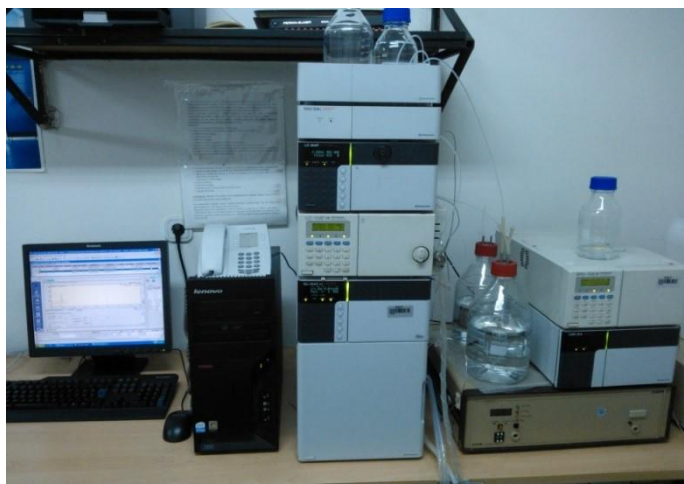
Slika 3.7. HPLC Shimadzu modularni sustav
