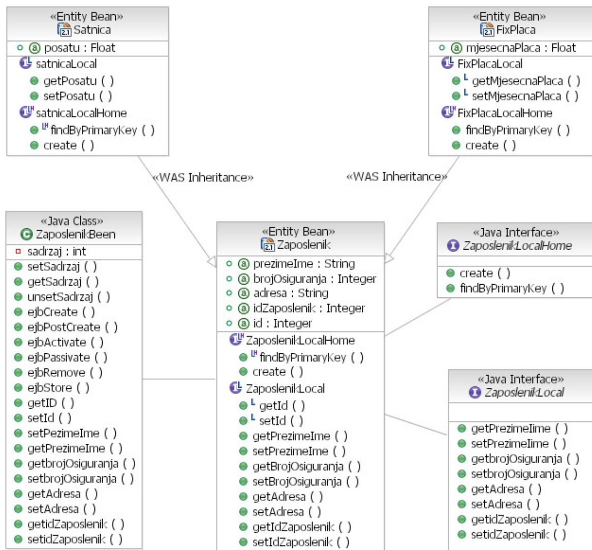
Slika 3-10. Primjer PSM modela za PIM model
