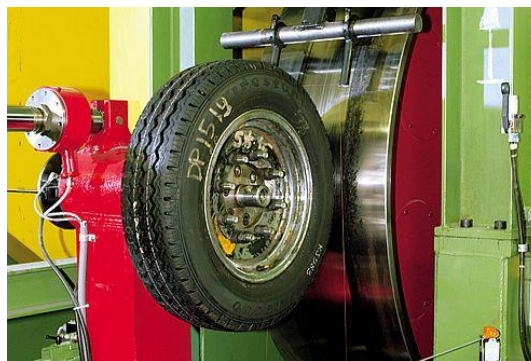
Slika 17. Bubanj za testiranje, [25]
