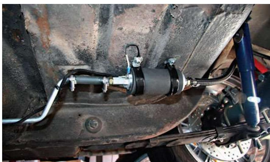
Slika 6. Električna pumpa za gorivo izvan spremnika [9]
