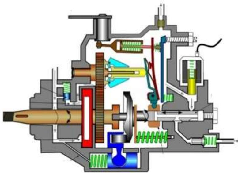
Slika 18. presjek VE-EDC pumpe [26]
