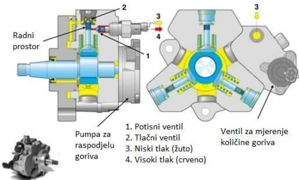
Slika 14. Visokotlačna pumpa [22]
