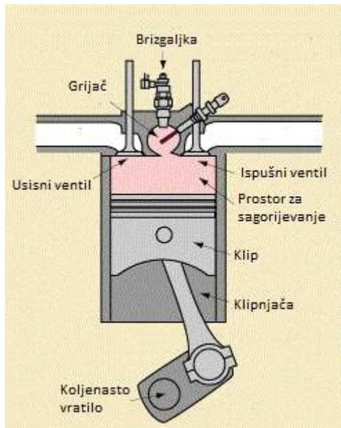
Slika 1. Osnovni skloovi četverotaktnog Diesel motora [1]
