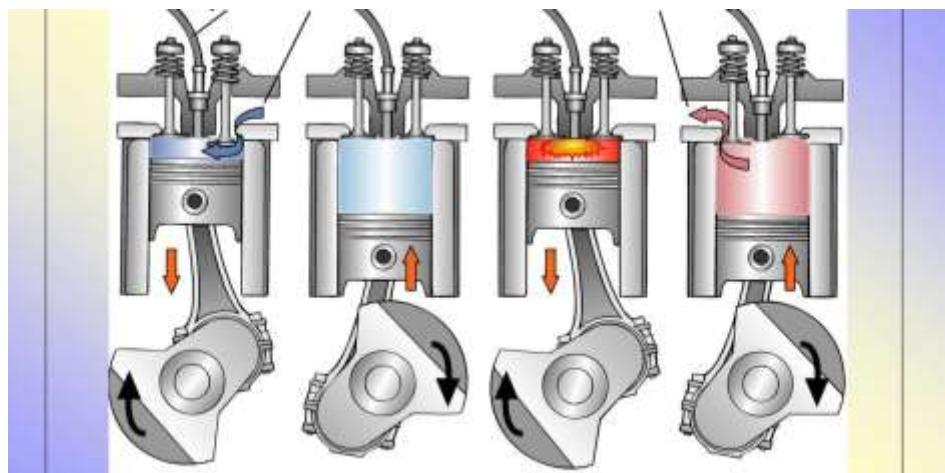
Slika 2. Slikoviti prikaz rada četverotaktnog Diesel motora [3]
