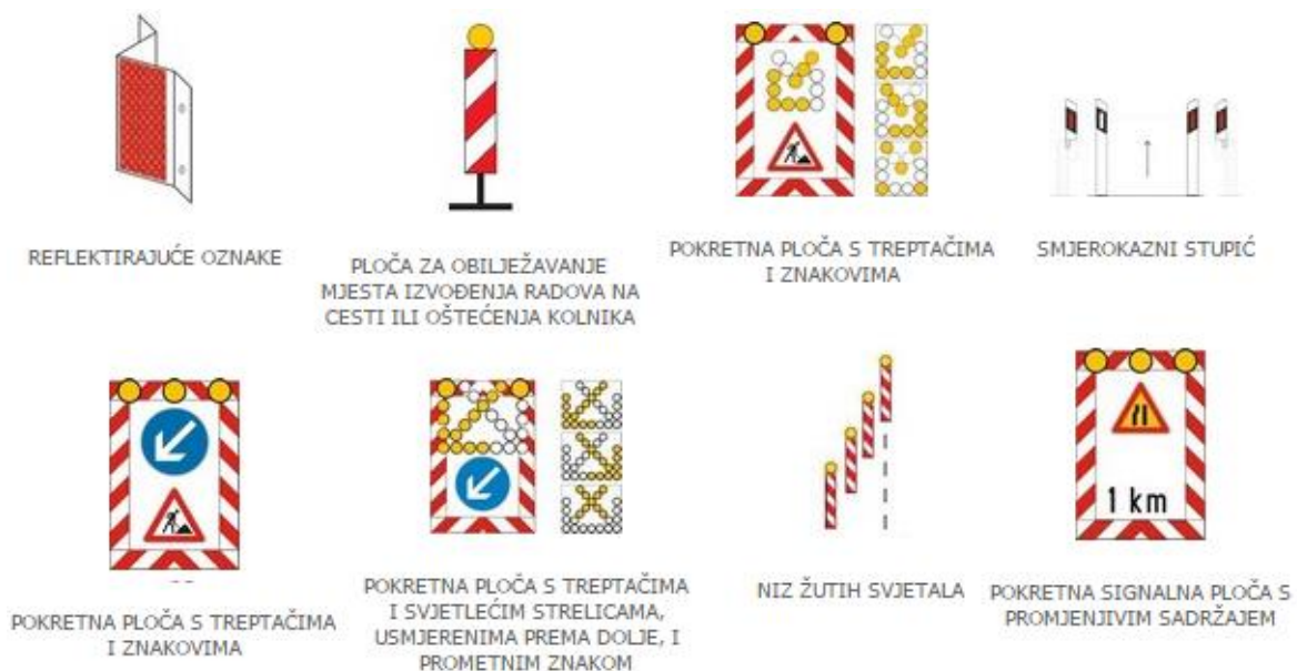
Slika 21. Signali za izvođenje radova, [9]
