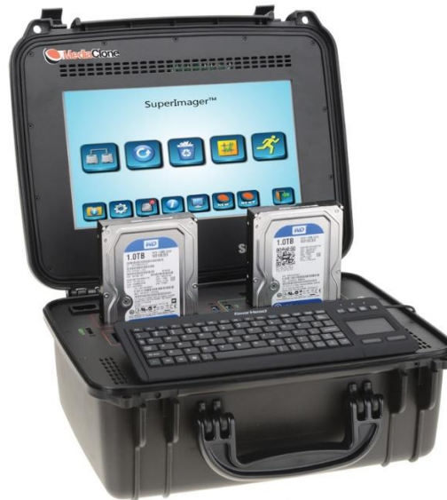
Slika 5. Forenzička mobilna jedinica za stvaranje forenzičkih slika tvrdog diska, [15]
