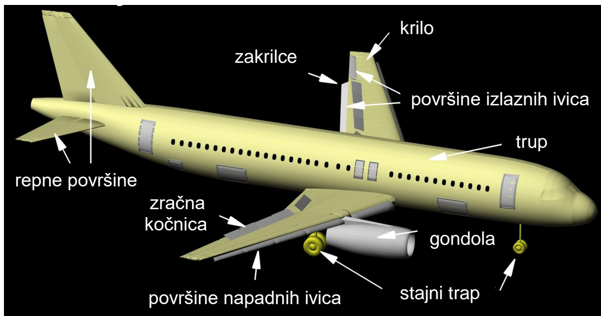
Slika 4. Općeniti prikaz izvora aerodinamičke buke, [6]
