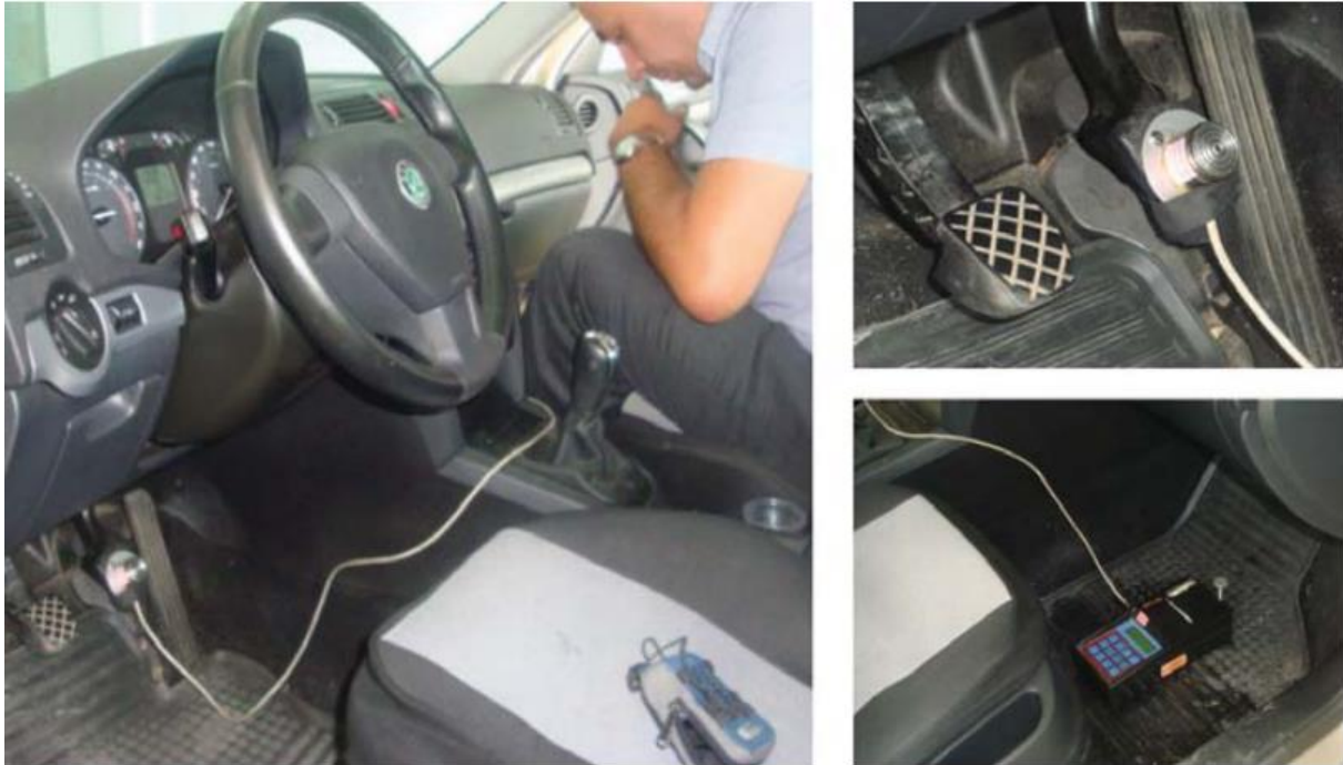
Slika 31. Postavljanje dinamometra i decelerometra u vozilo
