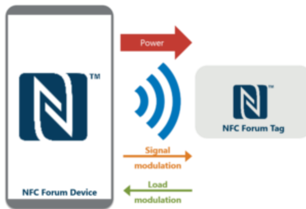
Slika 4. Princip rada NFC uređaja i oznake, [43]
