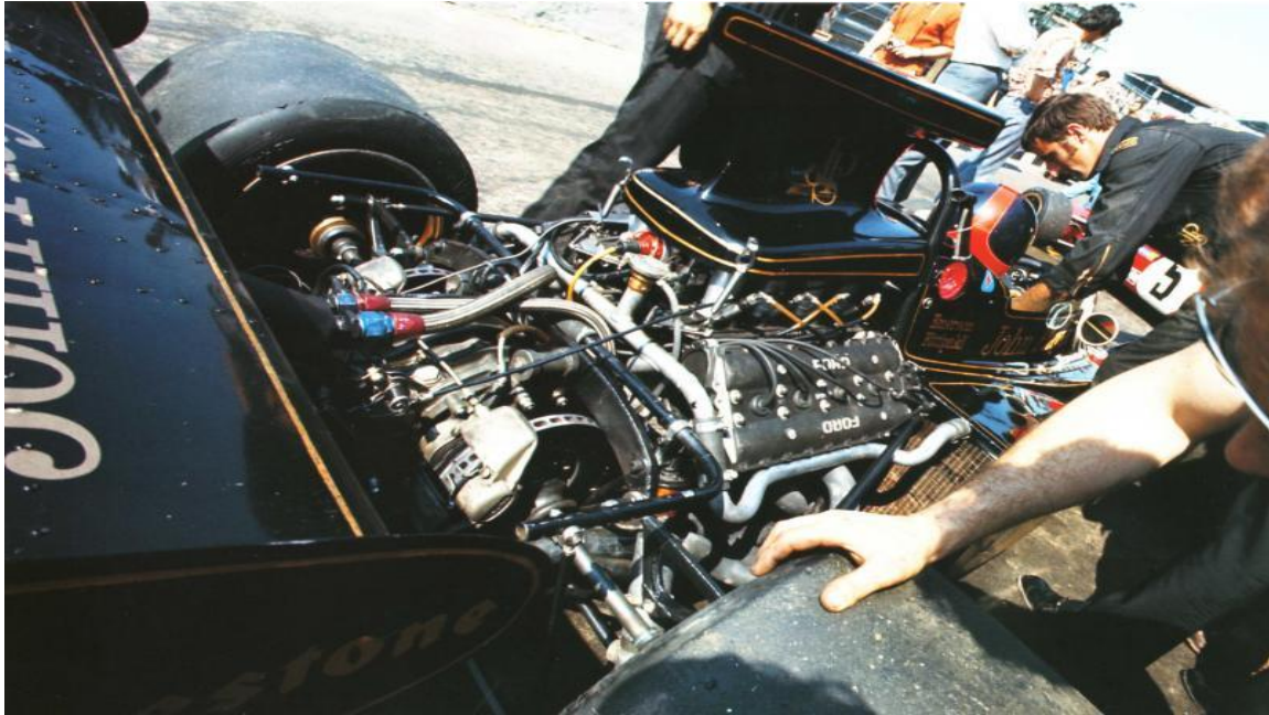
Slika 11. Ford-Cosworth DFV motor
