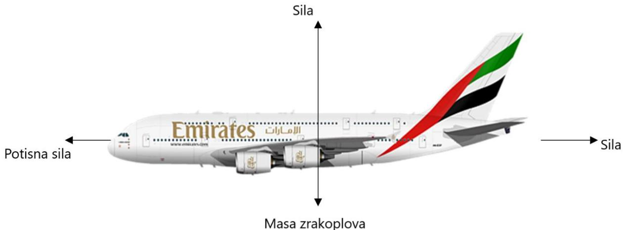
**Slika 1.** Djelovanje aerodinamičkih sila na zrakoplov
