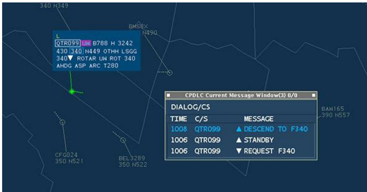
Slika 15 Prikaz kontrolorovog prozora za CPDLC komunikaciju
