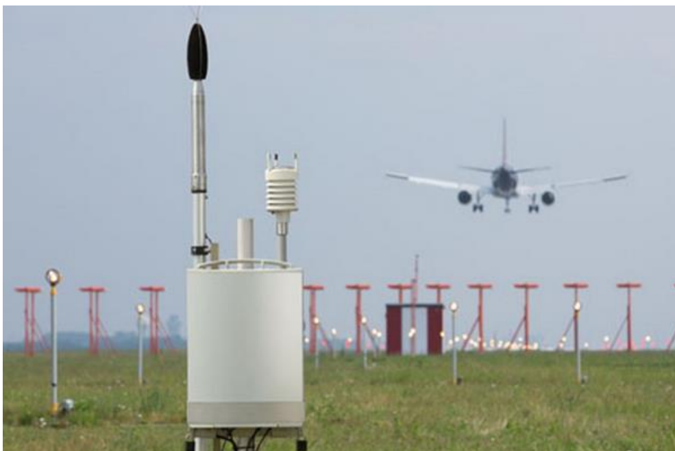
Slika 9. Prikaz NMT stanice s odgovarajućim mikrofonom, [26]
