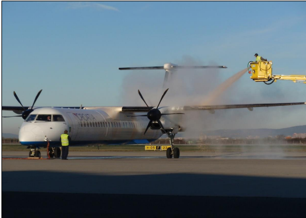
Slika 4. odleđivanje krila kemikalijom Type 1[8]
