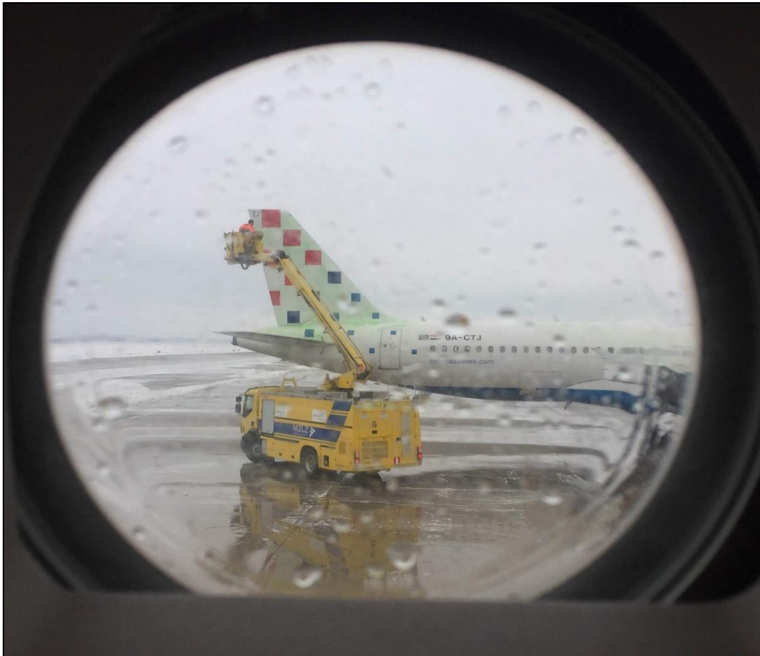
Slika 6. Odleđivanje zrakoplova kemikalijom Type 4 [Izvor:autor]
