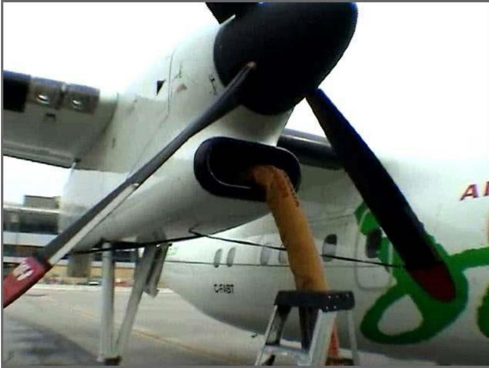
Slika 7. Odleđivanje toplim zrakom [10]
