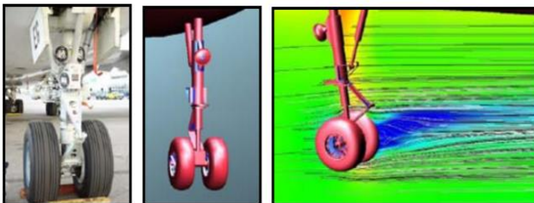
Slika 6 Prikaz analize opstrujavanja zraka oko nosnog kotača Boeing-a 747, IZVOR: [5]
