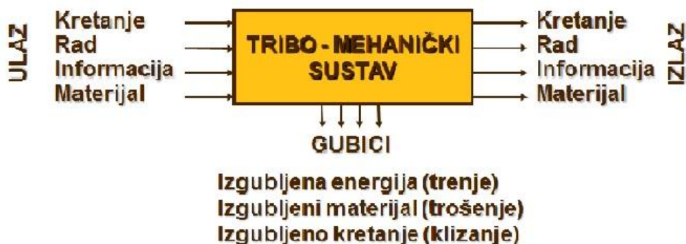
Slika 3.4. Shema tribomehaničkog sustava, [4]
