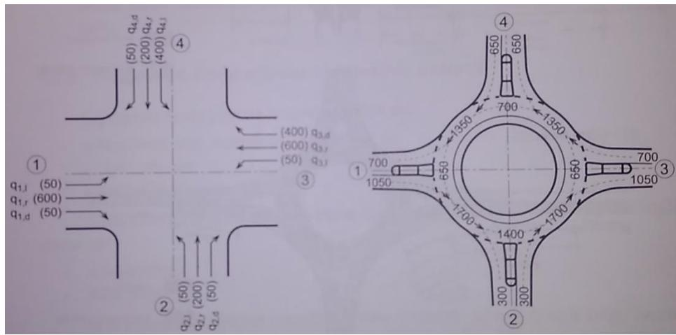
**Slika 19. Pretvorba brojenog prometa na klasičnom raskružju u kružno**
