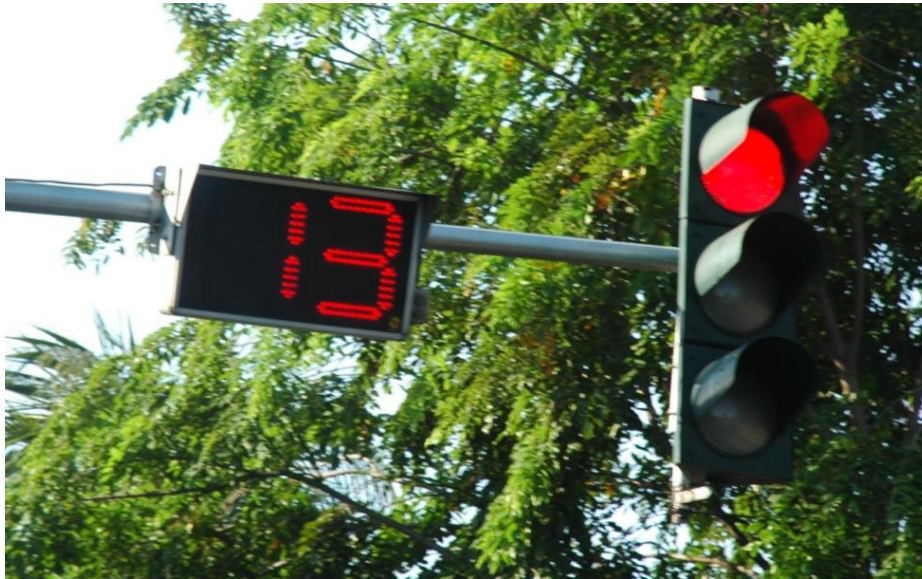
Slika 17: Brojač vremena na semaforskom uređaju u Jakarti
