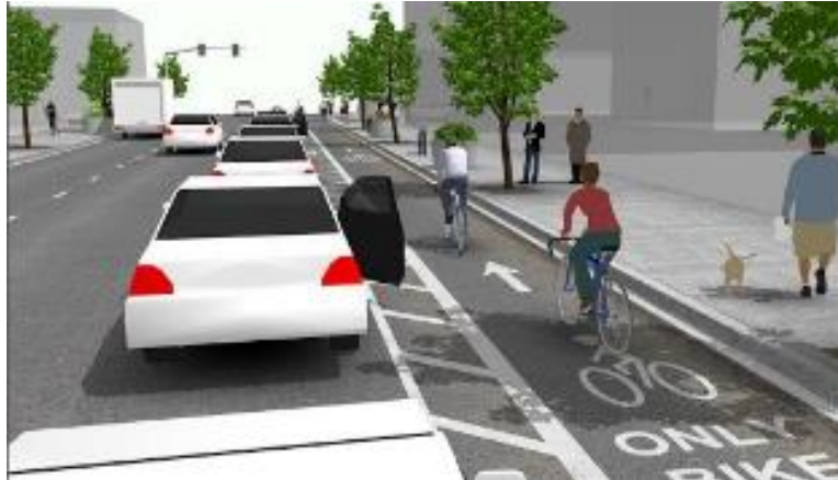
Slika 49. Biciklistička traka sa sigurnom zonom između Izvor: [5]
