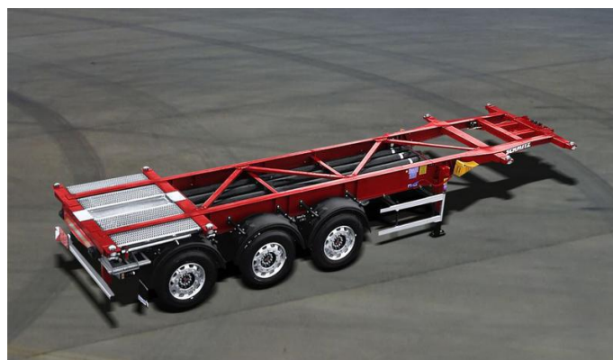
Slika 4. Rešetkasta poluprikolica za transport kontejnera
